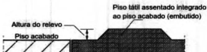
**Figura 75 – Detalhe do piso tátil integrado ao piso**
